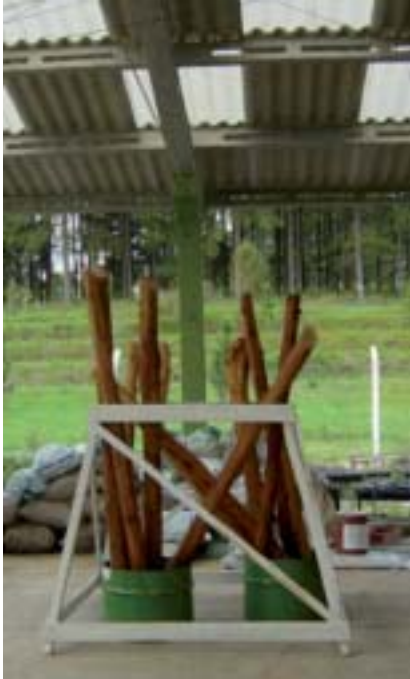
Figura 19 – Mourões de eucalipto em tambores com solução preservativa
