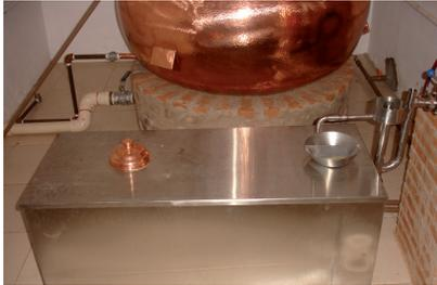
Figura 15. Caixa coletora de destilado
