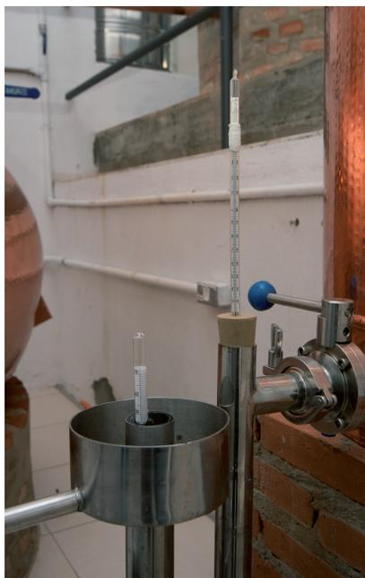
Figura 17. Proveta com alcoômetro e termômetro
