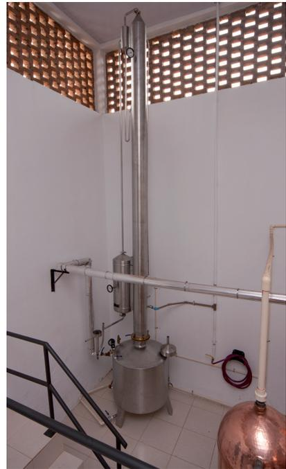
Figura 16. Coluna de destilação para produção de álcool carburante
