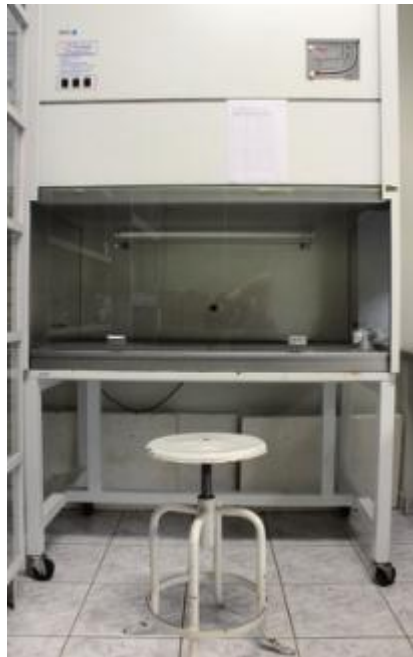
Figura 43. Câmara de fluxo para realizar a inoculação do fungo no substrato
