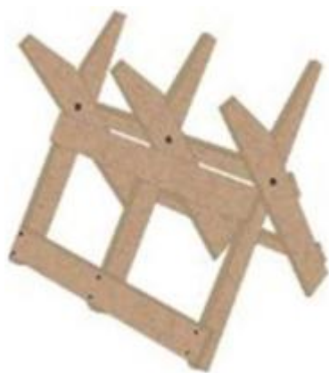
Figura 9. Cavalete adaptado para a confecção dos furos, inoculação do fungo e vedação para a produção de shiitake em toras de eucalipto
