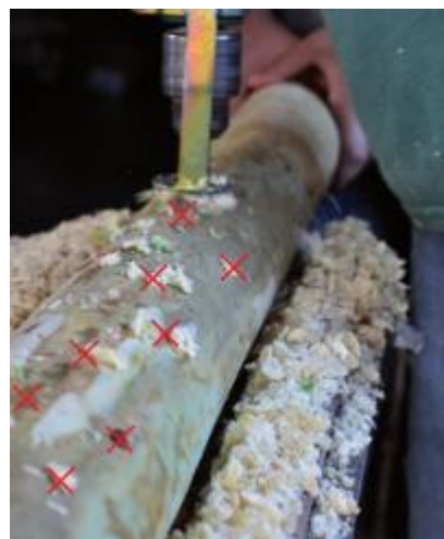
Figura 8. Realização dos furos na tora de eucalipto
