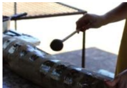
Figura 16. Vedação com parafina dos furos inoculados
