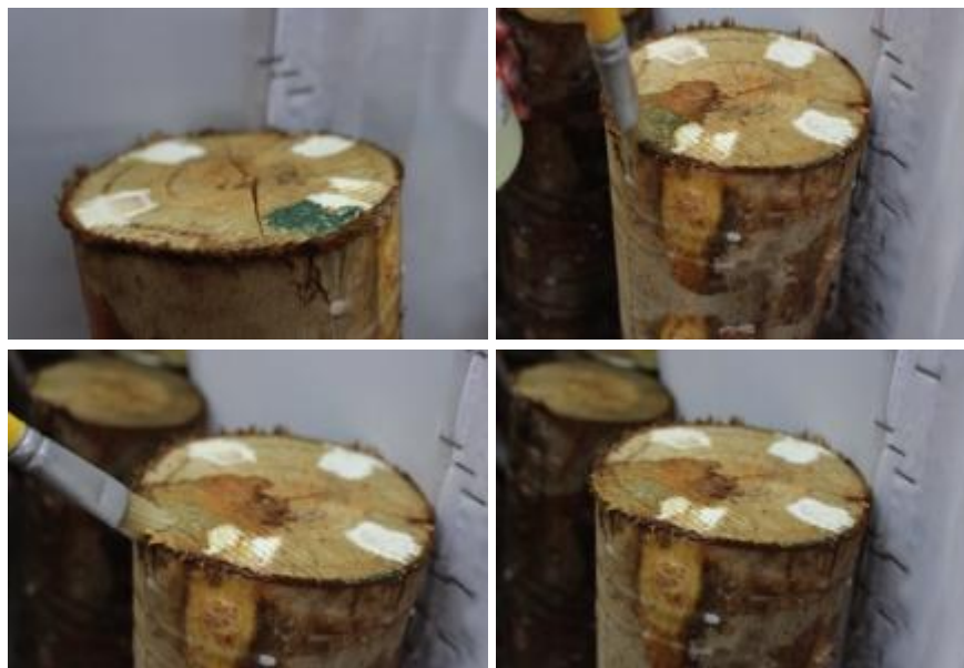
Figura 38. Limpeza das toras com água sanitária (Hipoclorito de sódio)
