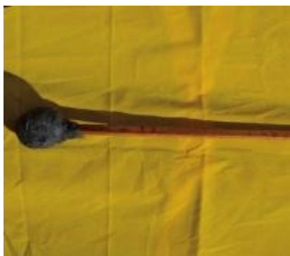
Figura 15. 'Trouxinha' usada para a parafinação e vedação dos furos
