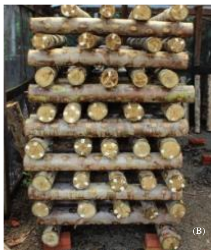
Figura 18. Empilhamento incorreto, tornando ambiente propício para contaminantes (A); Empilhamento efetuado corretamente (B)
