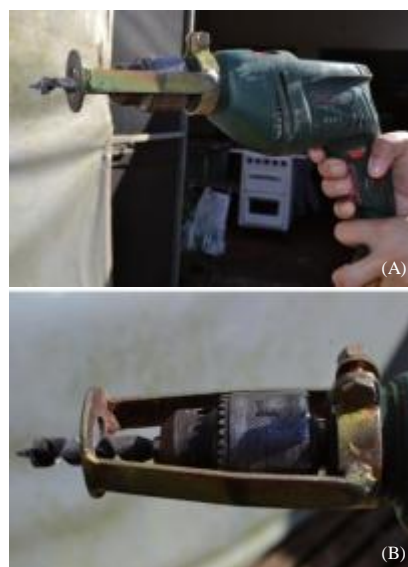
Figura 7. Furadeira de alta rotação com limitador de furo acoplado a máquina e broca de ½ polegada (A); Adaptador para realização dos furos (B)
