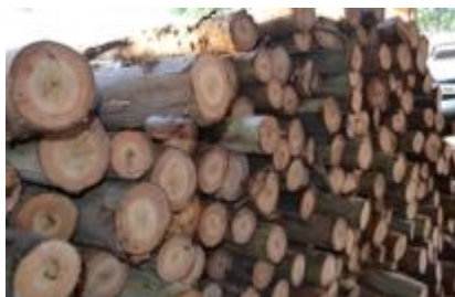
Figura 5. Empilhamento dos mourões em local sombreado
