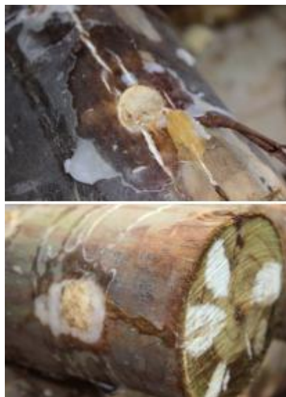
Figura 20. Alterações na casca e manchas brancas nas extremidades dos mourões
