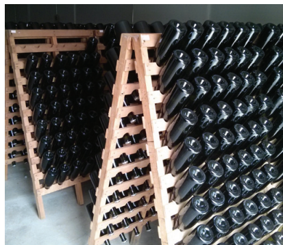
Figura 20. Garrafas de espumante armazenadas de forma a facilitar a retirada das substâncias sedimentadas
