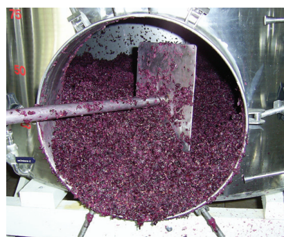
Figura 12. Limpeza das partes sólidas da uva restantes na máquina esmagadora
