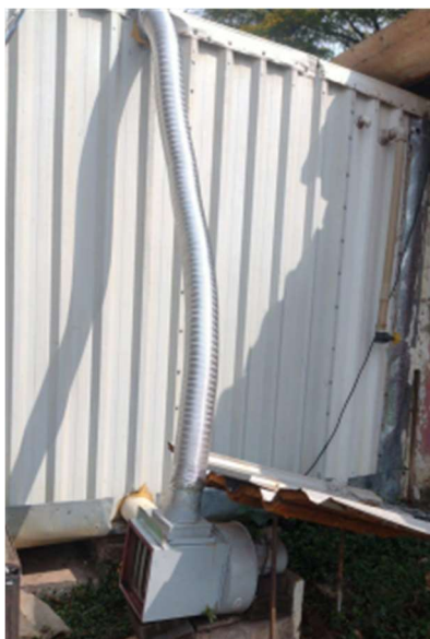
Figura 2. Pasteurizador em contêiner utilizado em escala comercial.
