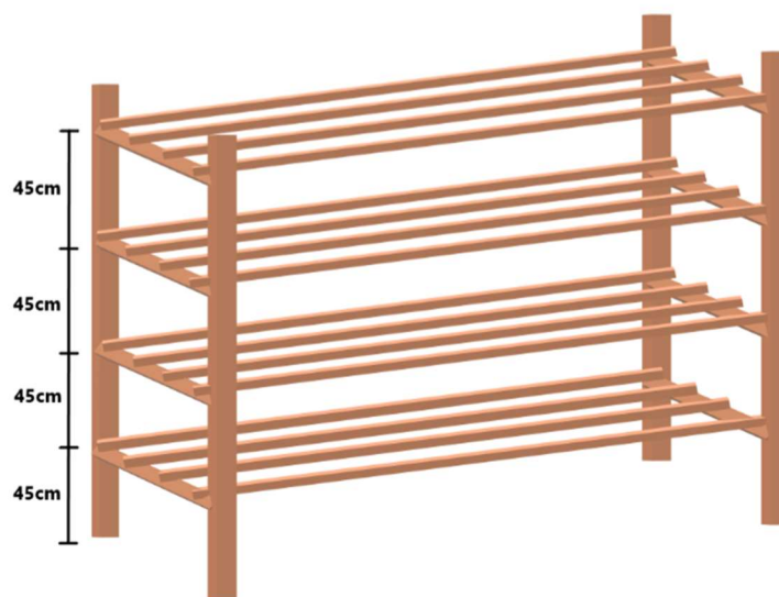
Figura 4. Estante de madeira para suporte dos sacos de substratos colonizados.
