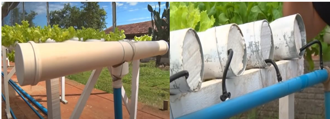
Figura 8. Conexões finais e iniciais dos perfis.
